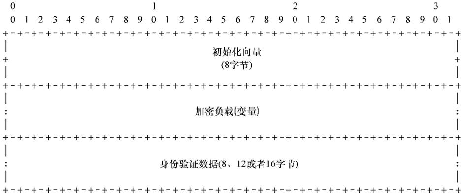
图 3-16 使用 AES/CCM 加密的 ESP 载荷
