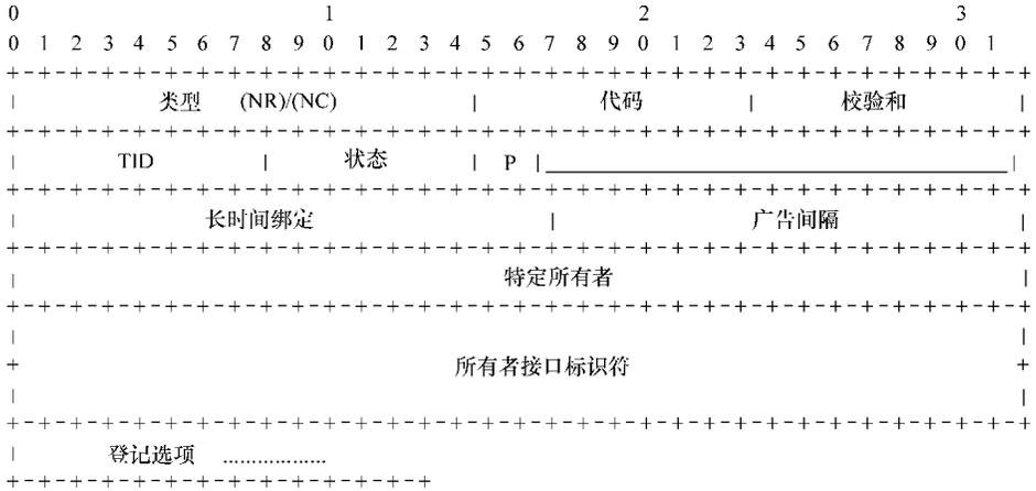
图 3-5 节点注册/确认报文的格式
