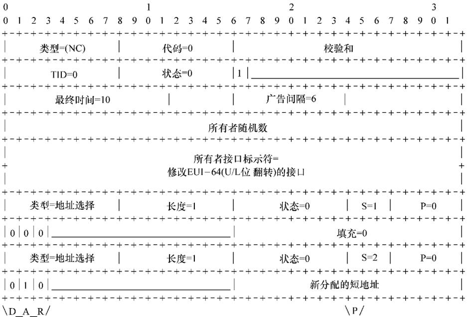
图 3-8 示例：有两个地址选项的节点确认
