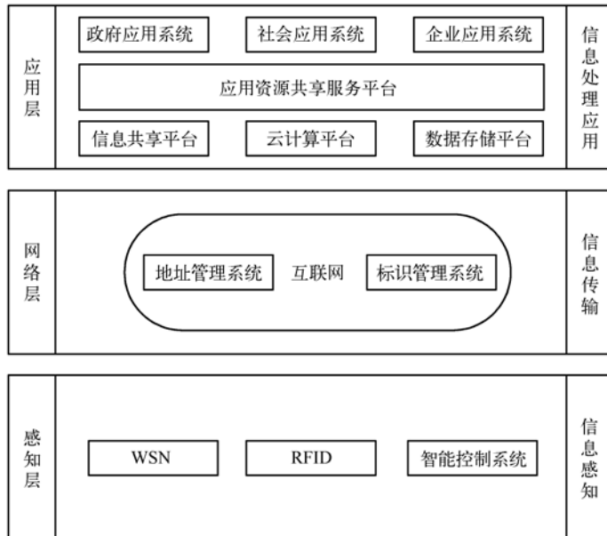
图 1.3 物联网体系结构图
