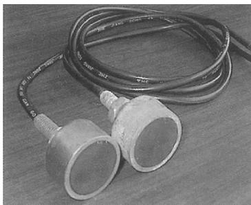
图 6-26 外壳静止型矢量水听器实物
