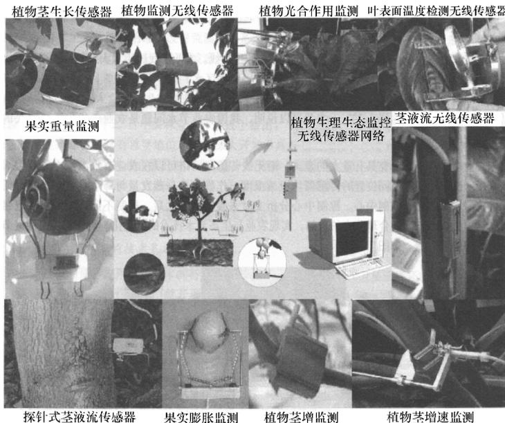
图 7-9 无线传感器网络应用于农业节水灌溉中的示例
