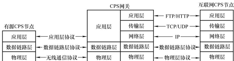
图 2-3 有源 CPS 节点与互联网 CPS 节点互连结构
