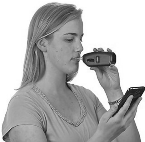
图 10-2 Breezing 是一个代谢跟踪器，由电池供电，与智能手机同步。产品包括一个用户交互应用（图片已获得 Breezing 公司授权）
