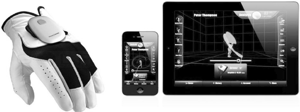
图 10-5 Golsense 惯性传感器用于高尔夫球挥杆的分析 (图片使用已获 Golsense 公司允许)
