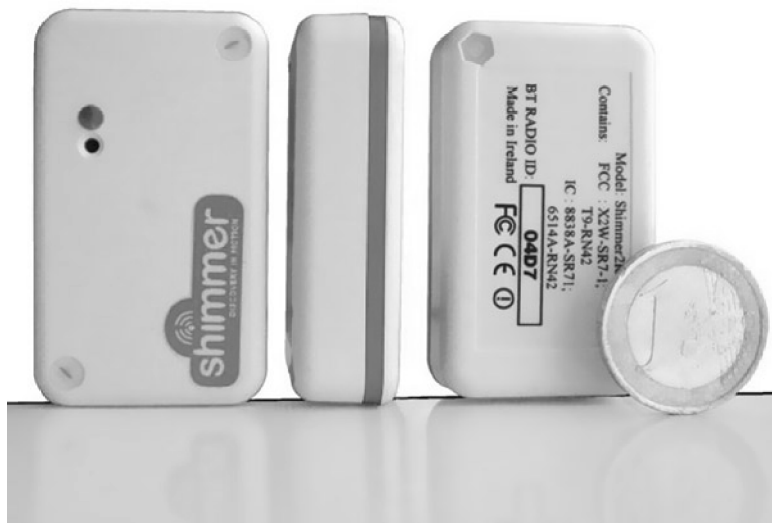
图 3-3 Shimmer 运动传感器（主板、子板和电池封装在一个定制传感器外壳里） （图片由 Shimmer Research 授权使用）
