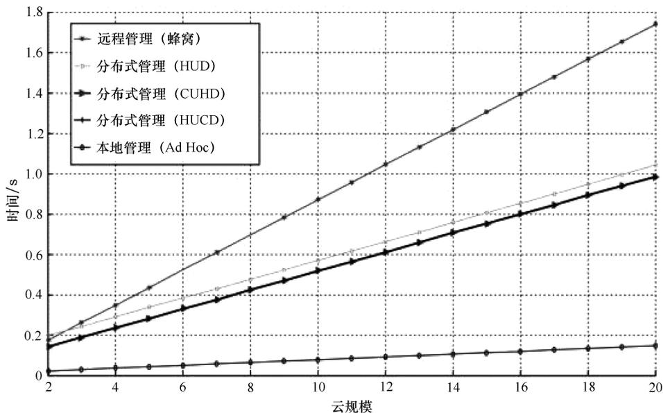
图 6-3 对于不同管理架构来说，形成规模为  $N$  的移动云所需的时间
