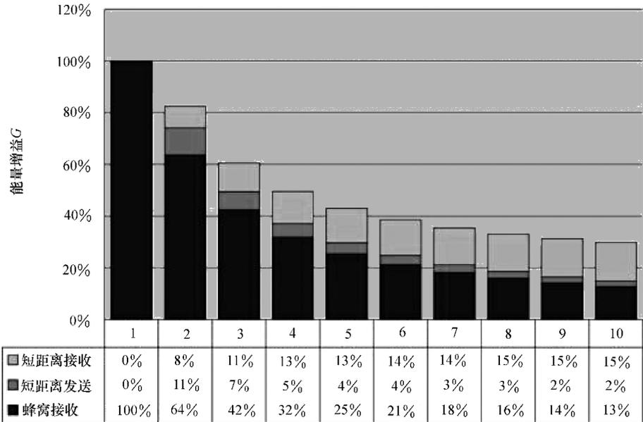
图 9-8 序贯本地交换 (SLE) 情形中的能量增益  $G$  与移动云中协作用户数之间的关系，可以将能耗分解为蜂窝链路上的能耗和短距离链路上的能耗
