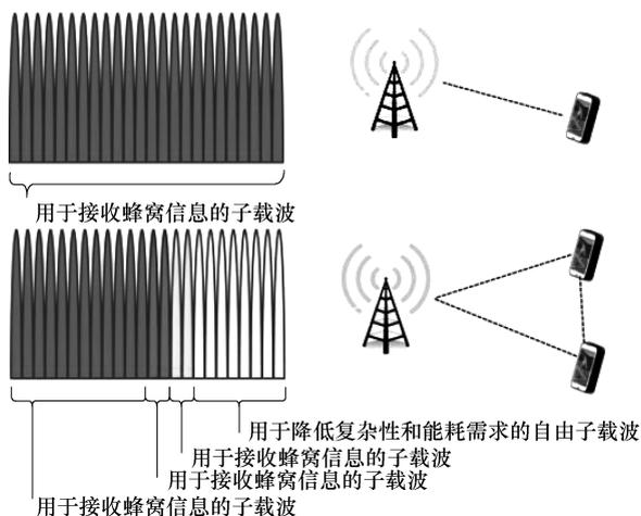
图 4-2 OFDM 子载波动态分配实例与独立设备情形的比较
