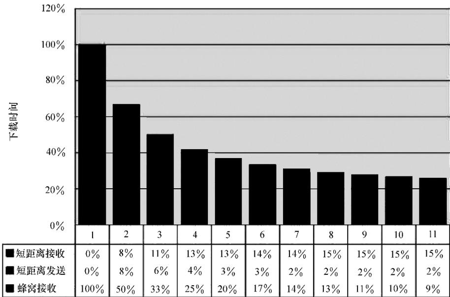
图 9-9 在序贯本地交换 (SLE) 情形中, 下载时间与移动云中协作用户数之间的关系, 可以将时间分解为蜂窝链路上所花费的时间和短距离链路上所花费的时间
