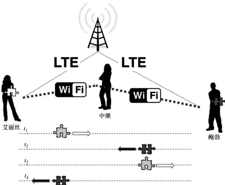
图5-6 在移动云中采用传统中继技术（不使用网络编码）来实现数据包的分发
