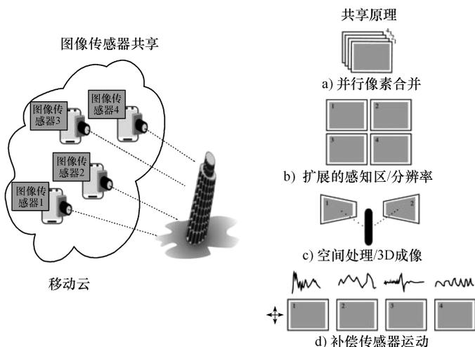
图 3-7 移动云中图像传感器共享的不同原理
