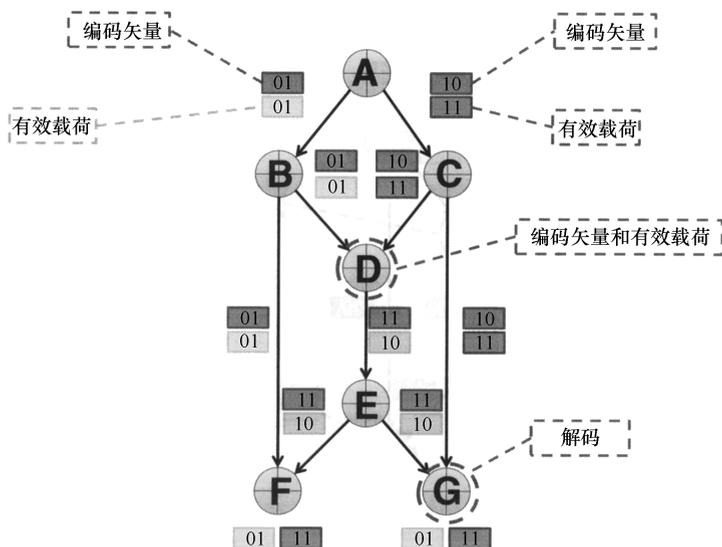
图 5-5 包含编码矢量的蝴蝶实例
