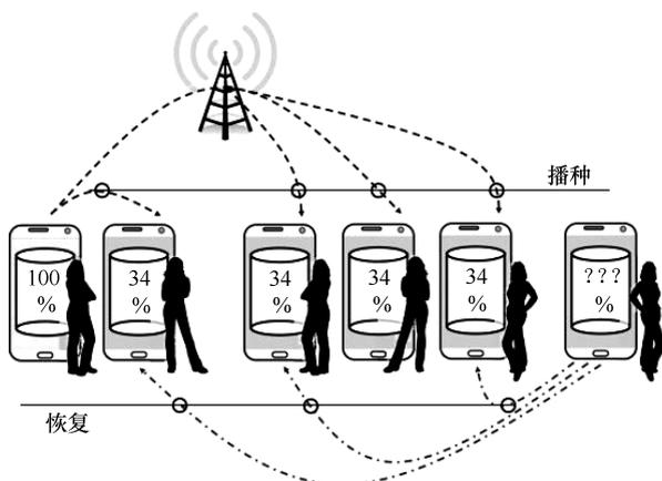
图 5-14 向移动云播种数据和从移动云中恢复数据的分布式存储实例
