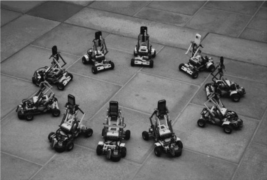
图 5-13 用于高移动性移动云内信息交换网络编码试验平台<sup>[29]</sup>
