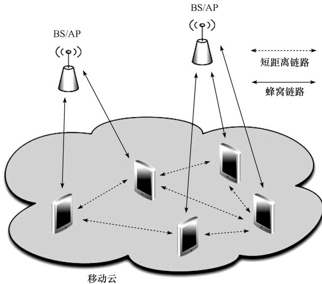
图 2-2 移动云的分布式-集中式基本架构
