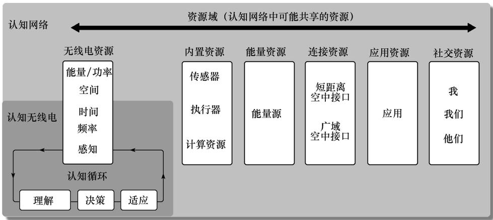
图 2-7 从认知无线电到认知网络：认知循环支持对公共资源状态的持续感知
