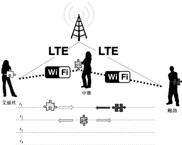
图 5-8 在移动云中采用中继技术和模拟网络编码来实现数据包的分发
