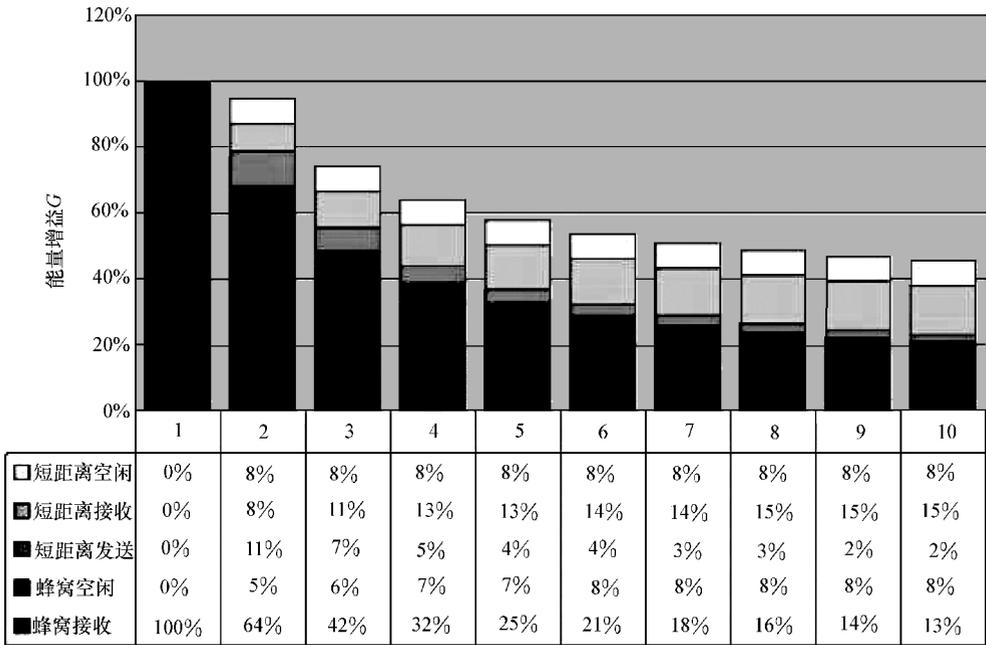
图 9-18 流媒体场景下的能耗与协作移动设备数，我们将能耗分解为蜂窝接收、蜂窝空闲、短距离发送、短距离接收和短距离空闲（从底部到顶部）
