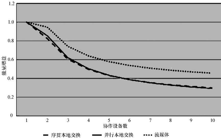
图9-19 序贯本地交换 (SLE)、并行本地交换 (SLE) 和流媒体方法能量增益方面的比较
