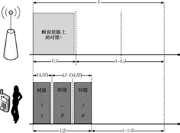
图 9-17 覆盖网络空中接口和短距离无线接口的活性结构
