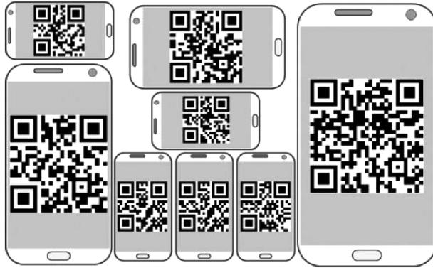
图 10-2 多台具有不同形状因子、以协作方式构建一个大显示屏的移动设备的定位情况，这些移动设备使用 QR 码，来协助检测位置和方向
