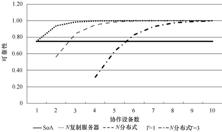
图 5-15 3 种不同存储方法的可靠性，故障概率为 25%
