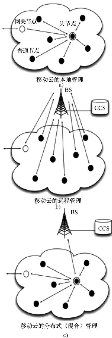
图 6-2 用于管理移动云的架构方法
