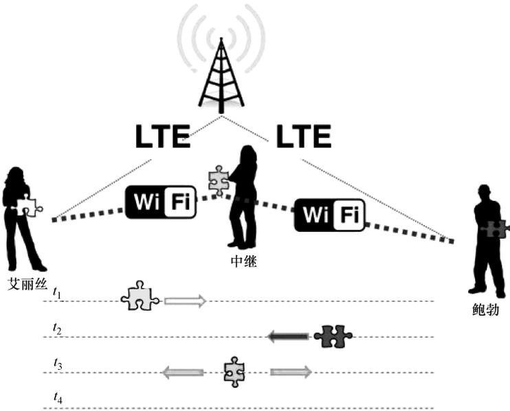
图 5-7 在移动云中采用中继技术和网络编码来实现数据包的分发
