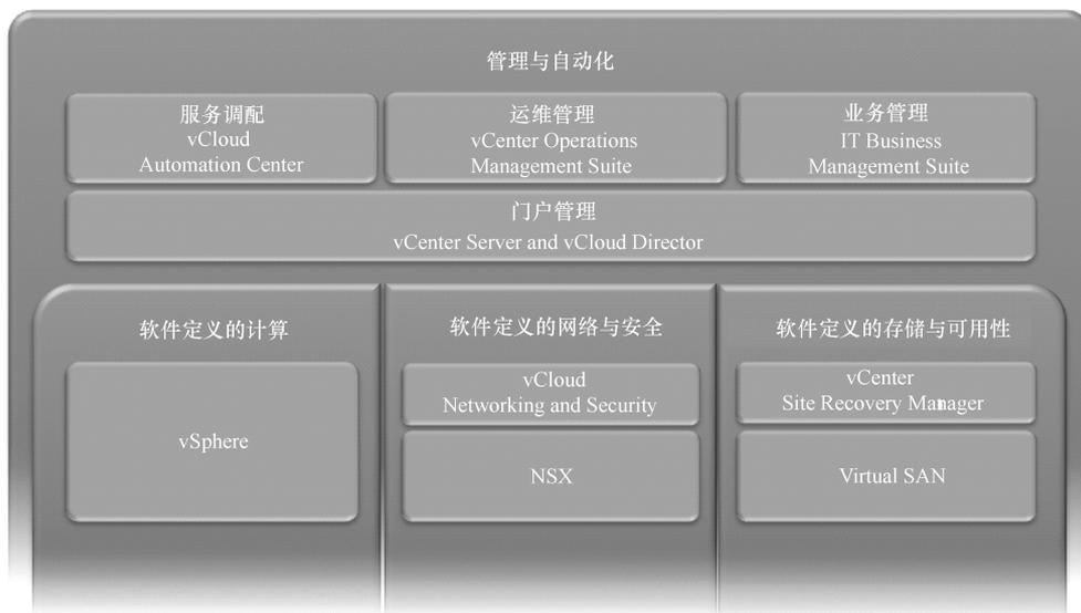
图 3-32 VMware 软件定义数据中心的整体架构
