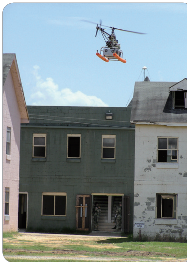
● 2006 年佐治亚理工大学的空中机器人正在自主识别出特定房屋并确定入口位置
