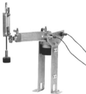
图 2-22 气流负压吸附取料机器人
