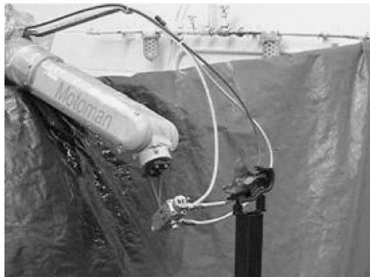
图 8-14 Motoman 喷涂机器人在喷涂的示意图
