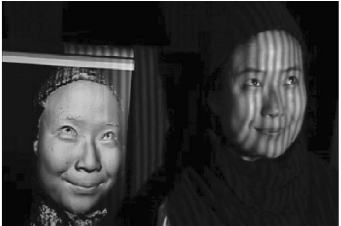
图 5.15 30 帧/s 下的同步 3D 数据采集、重建及显示。 来源：Zhang S 2010。转载获 Elsevier 许可
