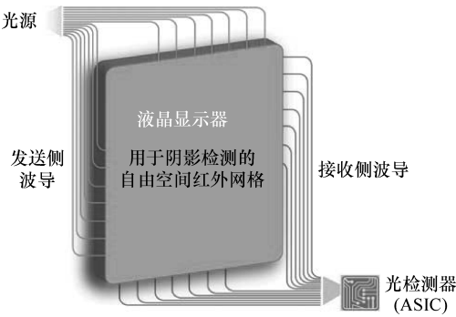
图 2.25 RPO 波导红外触控技术的概念图。来源: RPO
