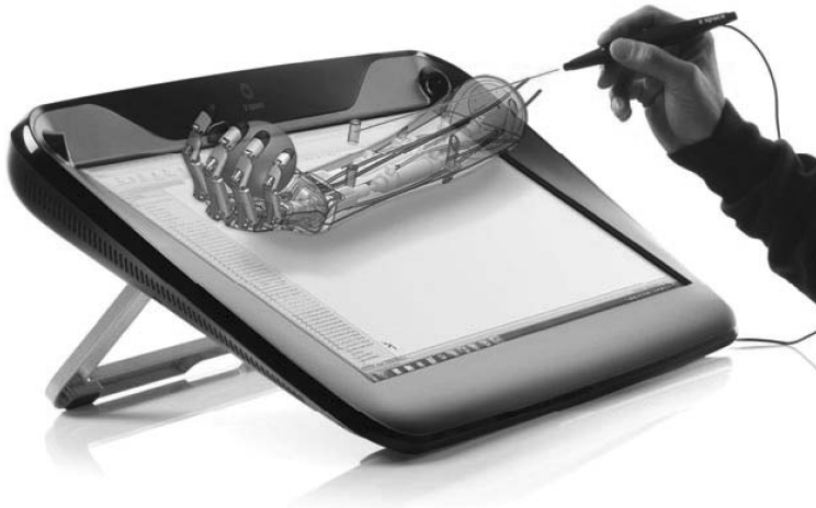
图 1.15 由 zSpace 生产的结合了运动视差效果和立体观测的交互式显示器图示。系统跟踪用户的头部运动并向用户展示了根据用户所处的位置而创建的立体图像对。手写笔被用于与显示器的虚拟对象进行实时交互。来源：www.zspace.com，转载获得许可
