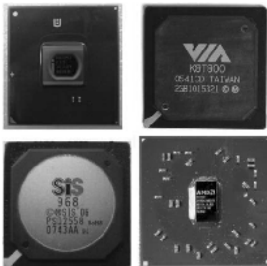
图 2-25 几种北桥芯片实物图
