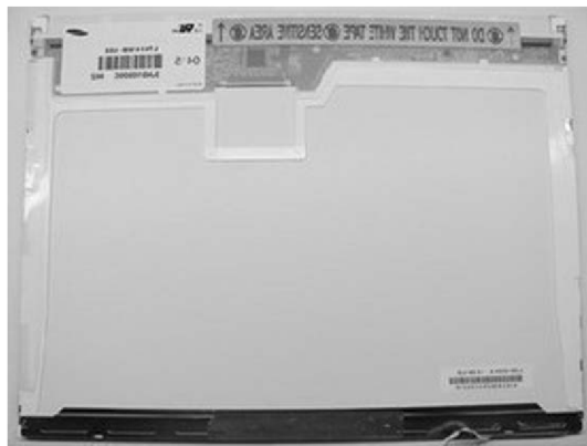
图 6-3 IBM R32 笔记本电脑原配液晶屏外形实物
