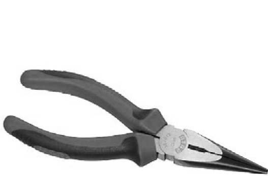
图 5-24 尖嘴钳外形实物
