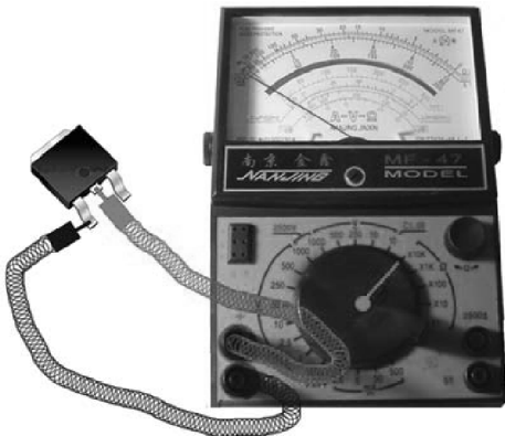
图 4-108 使用指针式万用表开路检测场效应晶体管步骤四
