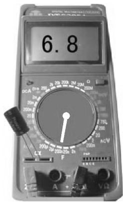
图 5-28 使用数字万用表测量电容
