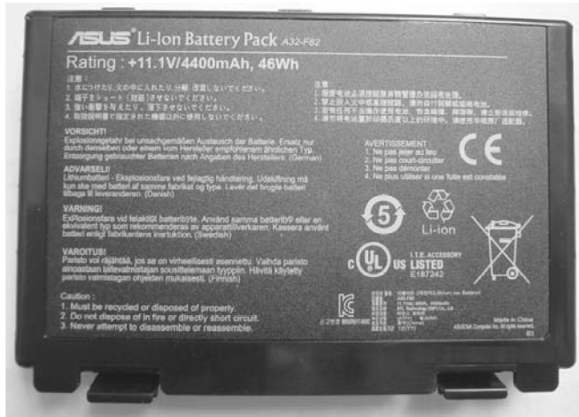
图 2-54 笔记本电脑锂离子电池外形实物
