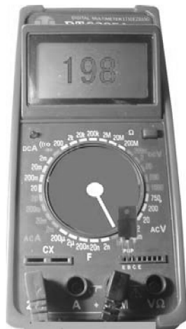
图 5-29 使用数字万用表测量晶体管 h_{\text{FE}} 值
