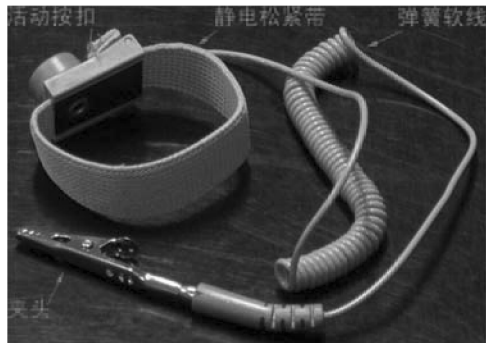
图 5-19 防静电手环外形实物结构
