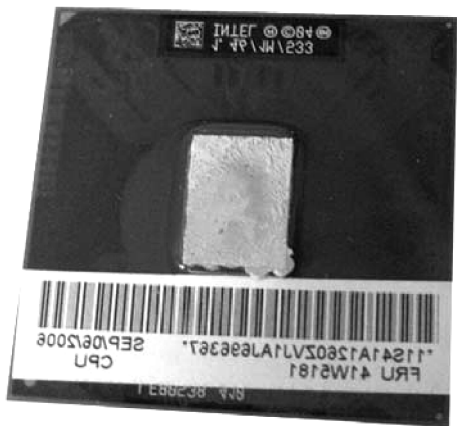
图 6-5 Intel 赛扬 M410 CPU 外形实物
