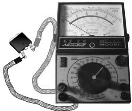
图 4-107 使用指针式万用表开路检测场效应晶体管步骤三
