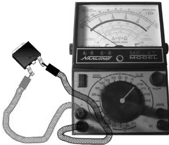
图 4-105 使用指针式万用表开路检测场效应晶体管步骤一
