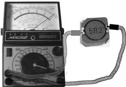
图 4-103 开路检测笔记本电脑中的封闭式电感
