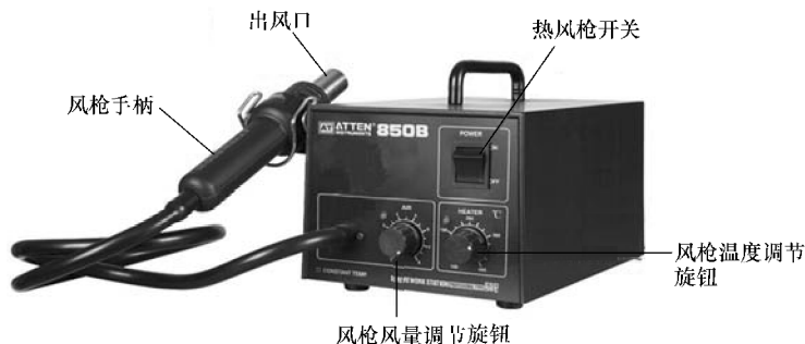
图 5-3 热风枪外部结构
