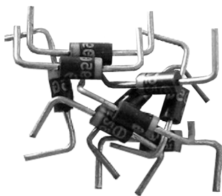
图 4-22 普通二极管外形实物
