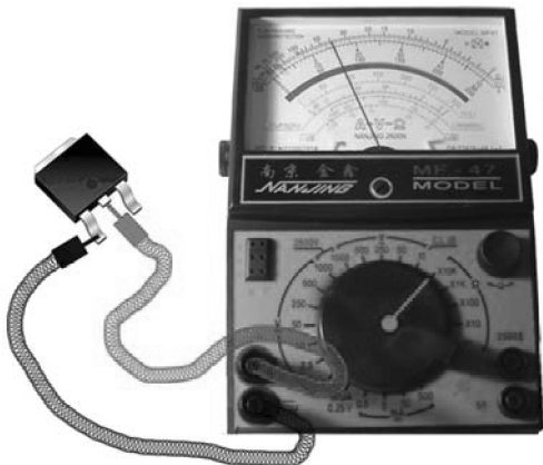
图 4-110 使用指针式万用表开路检测场效应晶体管步骤六
