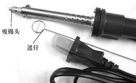
图 5-2 吸锡两用烙铁实物结构
