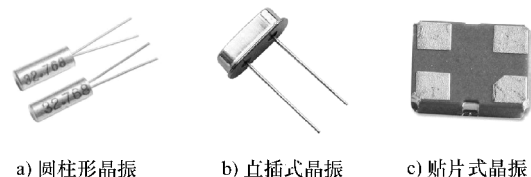
图4-36 几种常见晶振外形实物图
