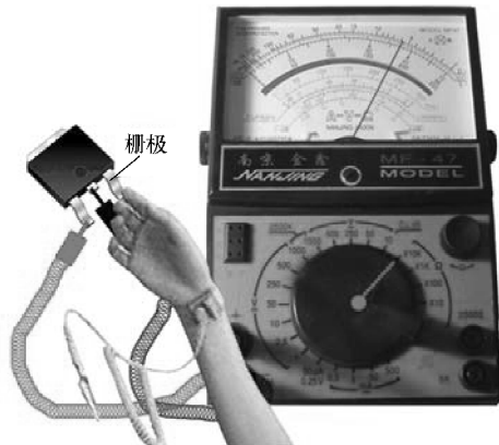
图 4-111 使用指针式万用表开路检测场效应晶体管步骤七
