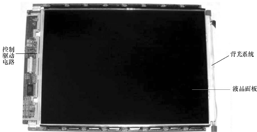
图 2-53 LCD 液晶显示屏的结构
