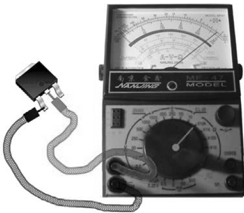
图 4-106 使用指针式万用表开路检测场效应晶体管步骤二
