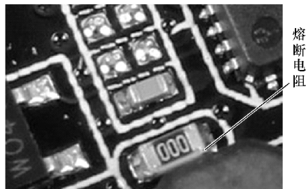
图 4-6 熔断电阻外形实物
