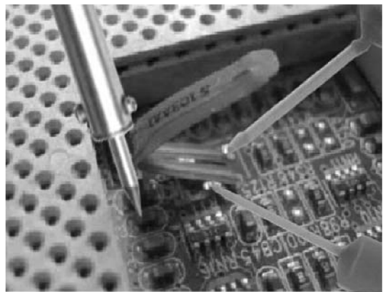
图 4-100 在路检测笔记本电脑主板 CPU 附近的热敏电阻示意图
