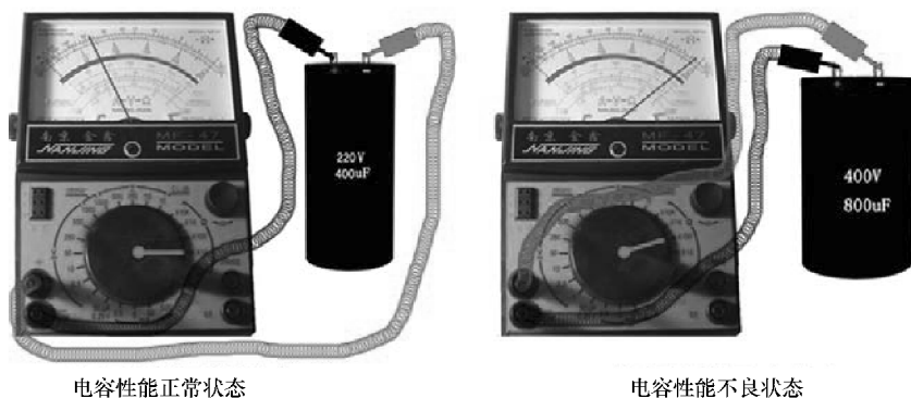
图 4-101 检测电解电容的性能
