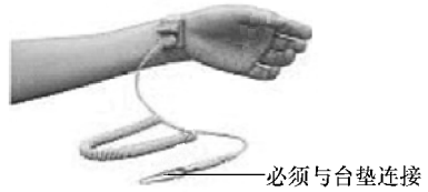
图 5-31 防静电手环佩戴方法示意图
