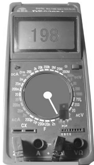
图 5-27 使用数字万用表测量晶体管 h_{FE} 值
