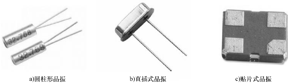
图 4-53 几种常见晶振外形实物图
