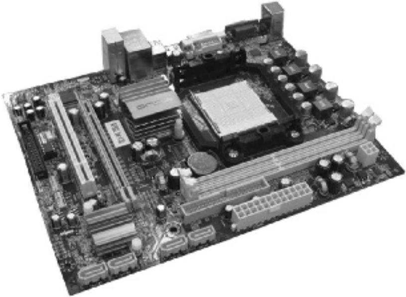
图 2-5 Micro ATX 板型实物结构图
