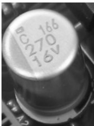
图4-29 主板常用日本化工固态铝电解电容
