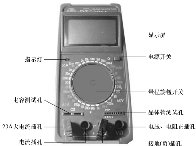
图 5-25 DT9205A 数字式万用表外形实物及面板功能键
