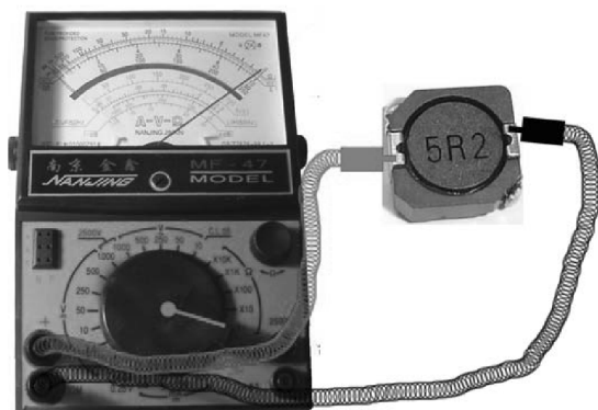
图 4-116 开路检测封闭式电感器方法
