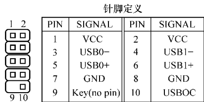
图 6-7 微星 MS-7388 (V1.X) 主板 USB 接口引脚定义
