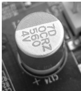
图4-31 主板常用立隆固态铝电解电容
