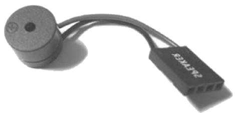
图 2-36 主板蜂鸣器外形实物图
