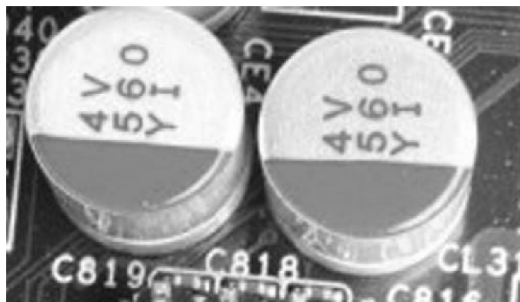
图4-30 主板常用万裕固态铝电解电容
