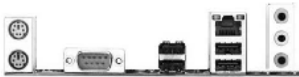
图 2-4 ATX 板型 I/O 面板插座功能图
