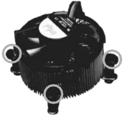
图 2-72 安装 CPU 风扇步骤 2 示意图
