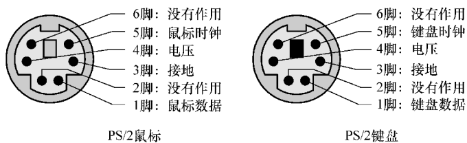
图 3-22 PS/2 键盘鼠标接口电路各引脚排列规律及功能
