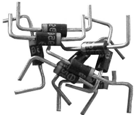
图 4-44 普通二极管外形实物图
