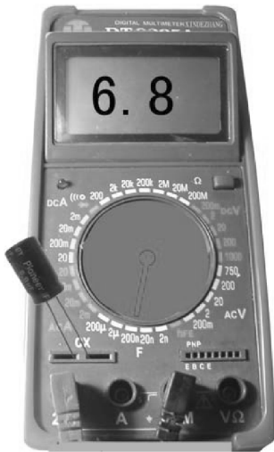
图 5-26 使用数字万用表测量电容
