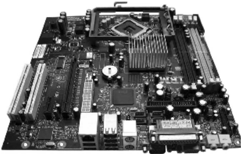
图 2-6 BTX 板型外形实物结构图
