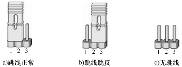
图 5-29 检测 CMOS 跳线状态示意图
