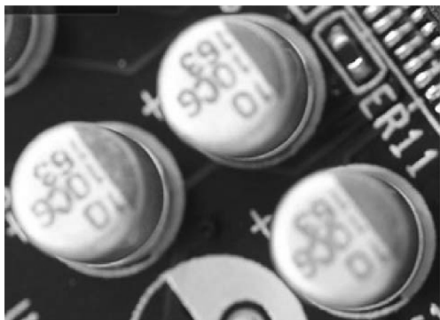
图4-28 主板常用松木固态铝电解电容
