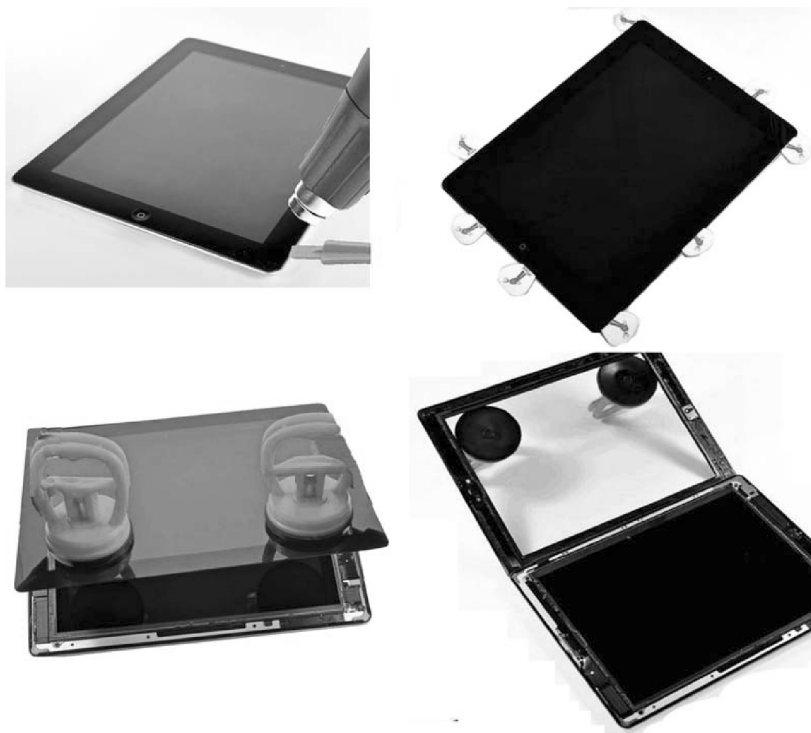
图 6-33 移除 iPad 的面板连接
