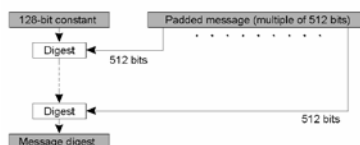
图7-13 MD5算法的结构
