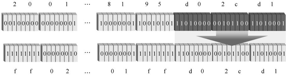
图 2-12 请求节点多播地址的推导<sup>[15]</sup>
