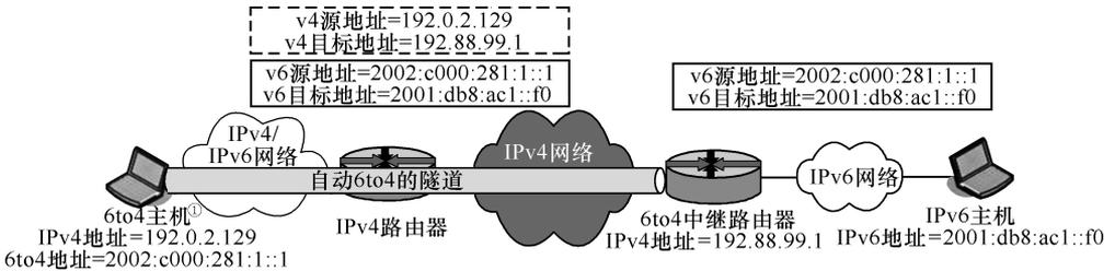
图 3-10 6to4 主机和纯 IPv6 主机通信<sup>[39]</sup>
