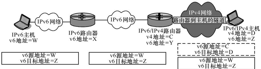
图 3-6 路由器到主机的隧道配置<sup>[28]</sup>
