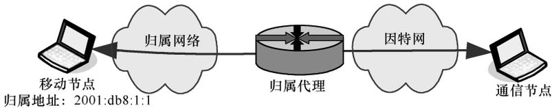
图 2-17 归属移动的移动 IPv6
