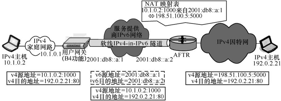
图 3-34 轻型双栈体系架构<sup>[68]</sup>
