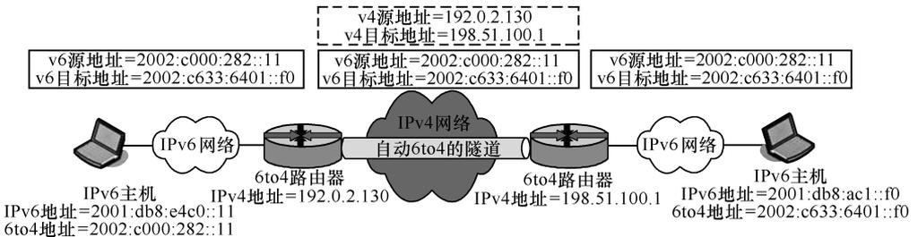
图 3-9 6to4 隧道的例子<sup>[39]</sup>
