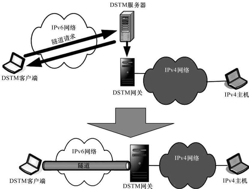
图 3-18 DSTM 隧道设置<sup>[39]</sup>
