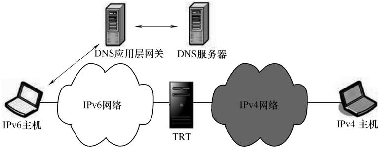
图 3-27 使用 DNS-ALG 的 TRT 配置<sup>[57]</sup>
