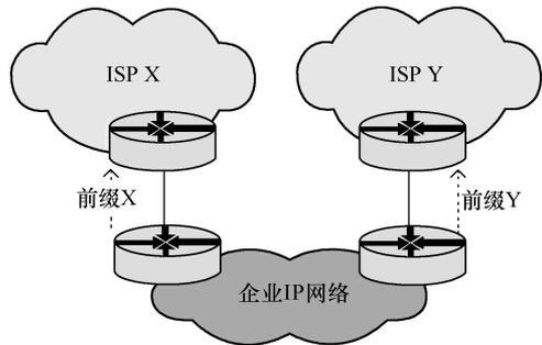
图 5-4 多重连接架构
