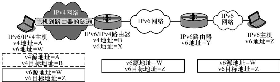
图 3-5 主机到路由器的隧道配置<sup>[28]</sup>
