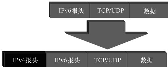
图 3-3 IPv6 上的 IPv4 隧道<sup>[28]</sup>
