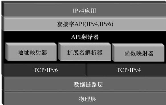
图 3-21 BIH 基于套接字的体系结构
