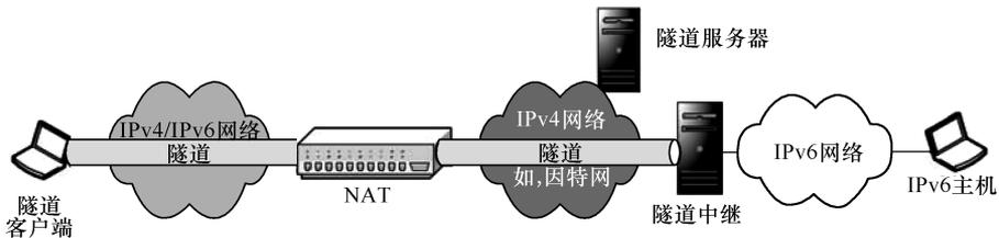
图 3-14 Teredo 客户端到 IPv6 主机的连接<sup>[39]</sup>
