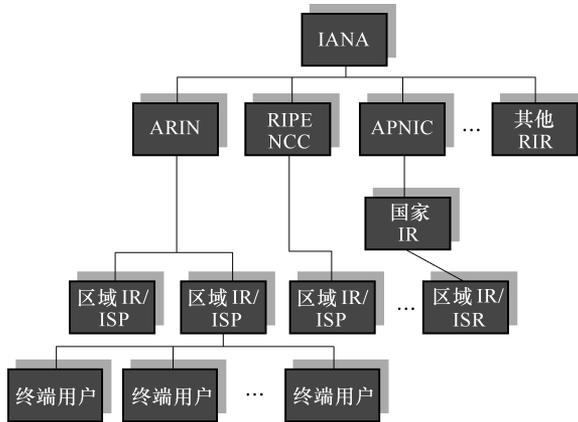
图 5-1 自顶向下的 IP 地址分配<sup>[4]</sup>
