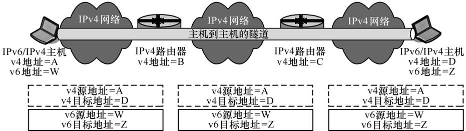
图 3-7 主机到主机的隧道配置<sup>[28]</sup>
