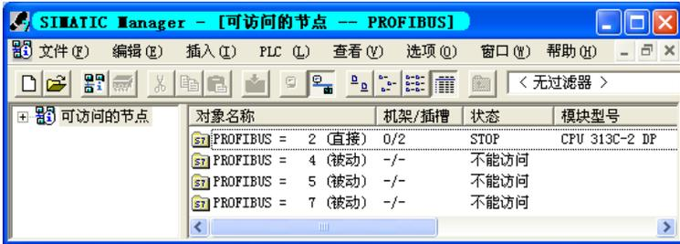
图 6-4 PROFIBUS 网络上的可访问节点
