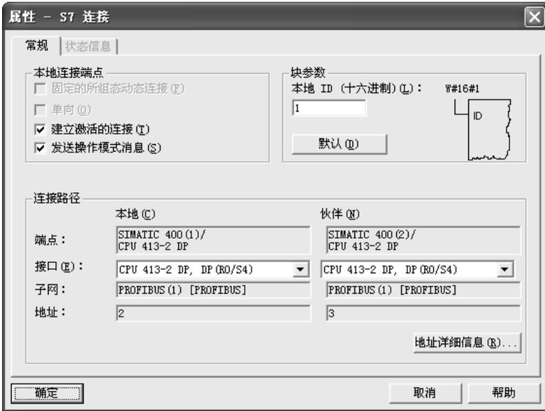
图 4-27 2 号站的 S7 连接属性对话框
