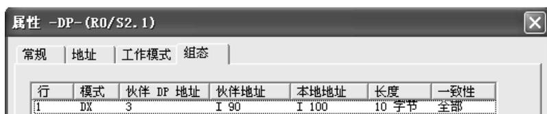
图 5-20 组态 4 号主站的通信 I/O 区
