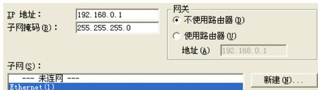
图 15-17 HMI 的以太网接口属性对话框
