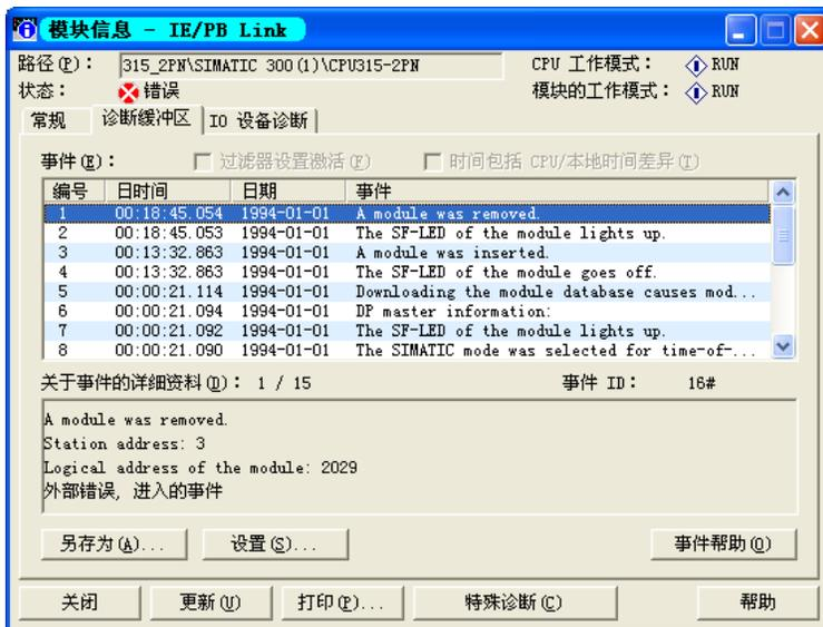
图 11-32 IE/PB Link 的模块信息对话框
