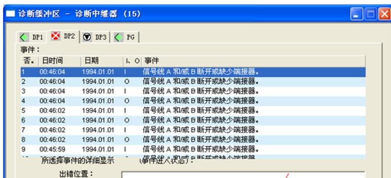
图 6-56 诊断中继器网段 DP2 的诊断缓冲区
