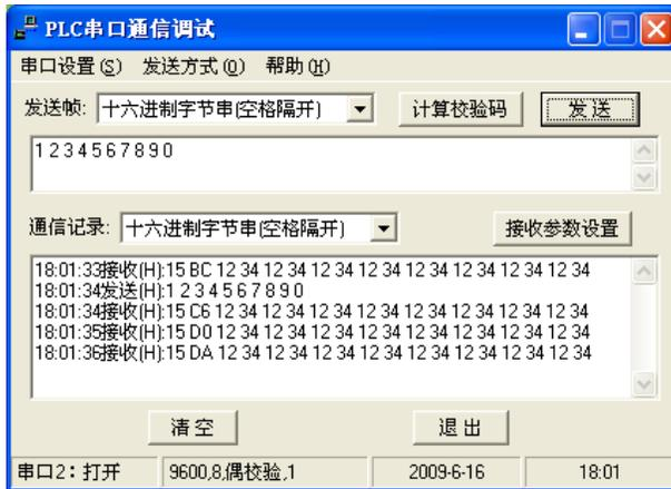
图 15-6 串口通信调试对话框
