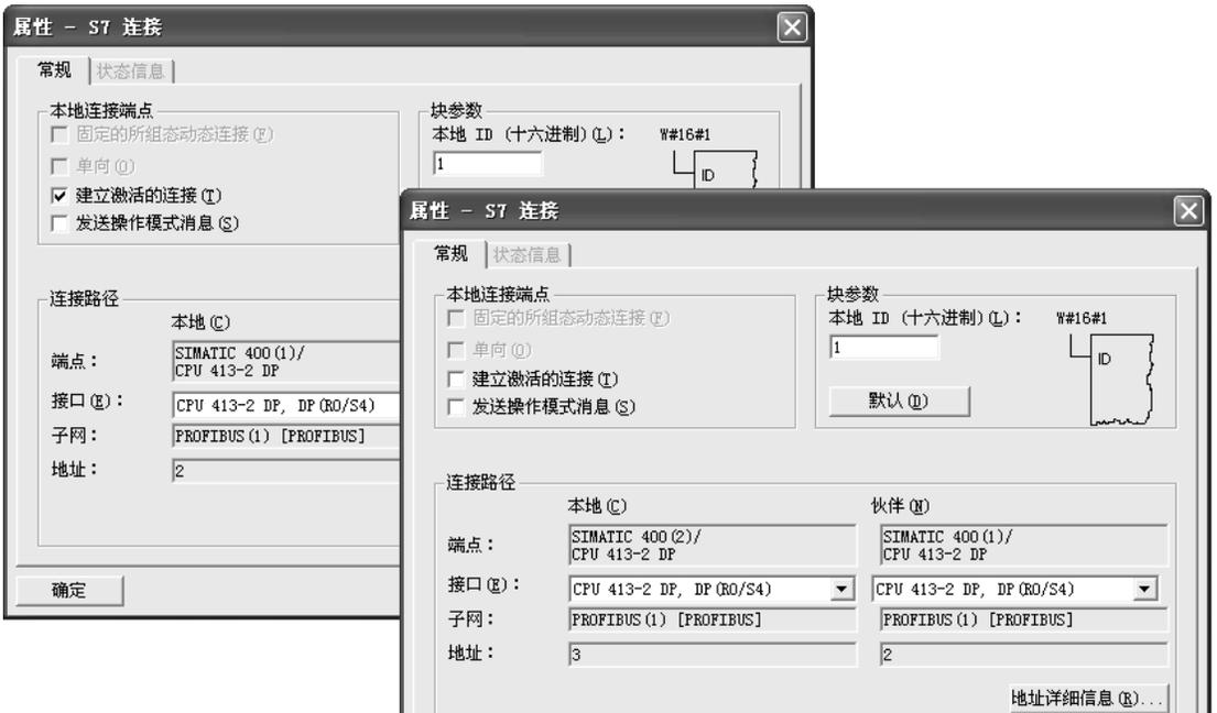
图 4-17 通信双方的 S7 连接属性对话框
