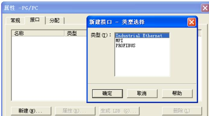
图 15-9 生成 PG/PC 的以太网接口
