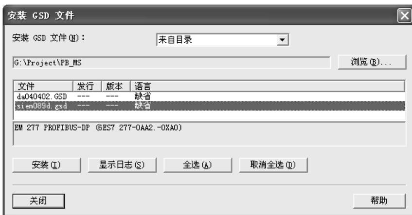
图 3-12 “安装 GSD 文件”对话框
