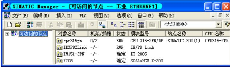
图 6-6 PROFINET 网络上的可访问节点
