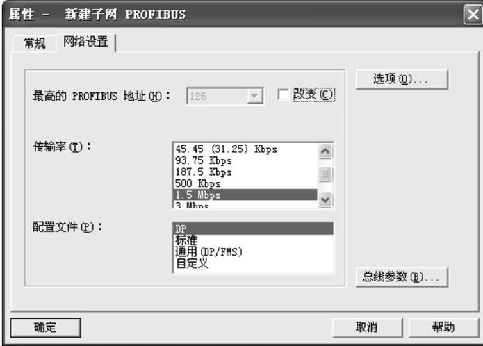
图 3-5 组态 PROFIBUS 网络参数
