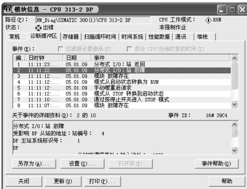
图 6-16 CPU 的模块信息对话框
