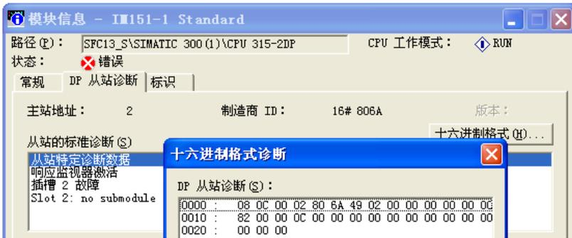
图 7-24 IM 151-1 模块信息中的诊断信息
