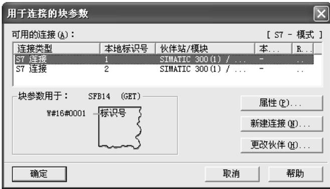
图 4-13 用于连接的块参数对话框
