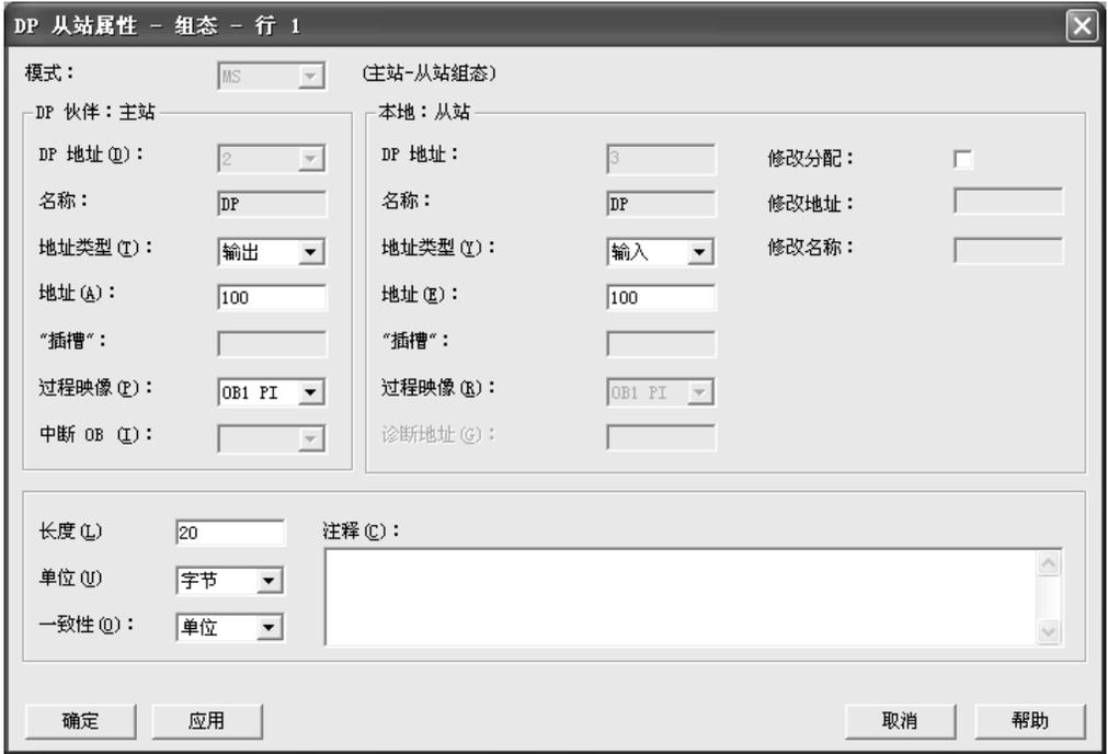
图 3-20 组态 DP 主从通信的输入/输出地址区
