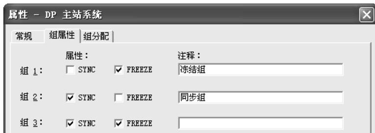
图 5-33 设置 SYNC/FREEZE 组的属性
