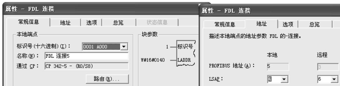
图 4-34 5 号站的 FDL 连接属性对话框
