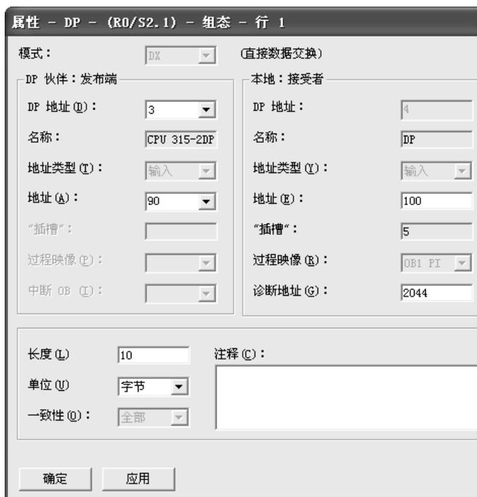
图 5-21 直接数据交换的参数设置
