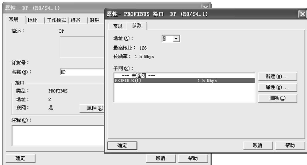
图 3-4 PROFIBUS 接口属性对话框
