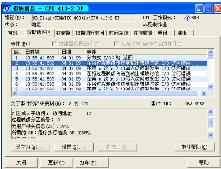
图 6-28 CPU 的诊断缓冲区
