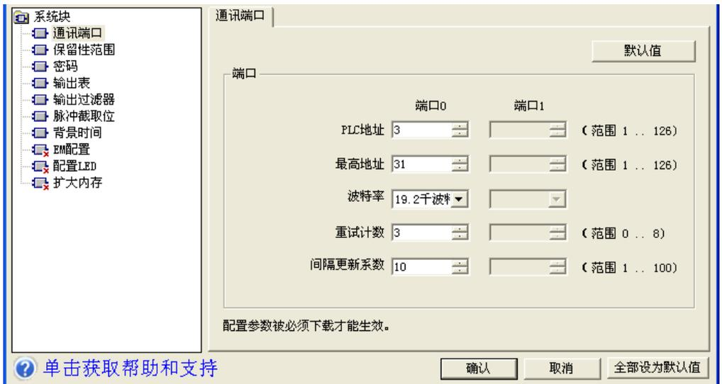
图 14-40 设置 S7-200 的通信接口
