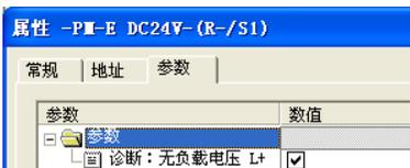
图 7-14 组态 ET 200S 的电源模块
