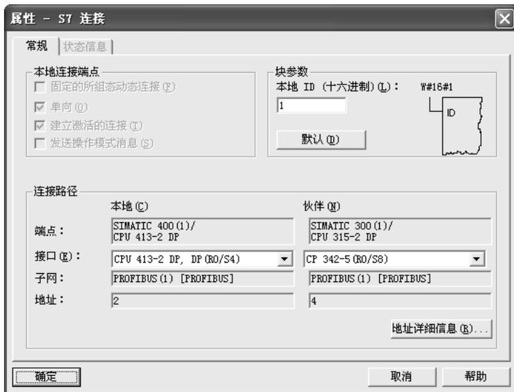
图 4-10 S7 连接属性对话框
