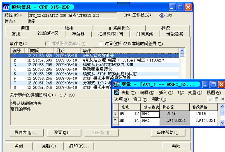
图 8-14 CPU 模块信息的诊断缓冲区
