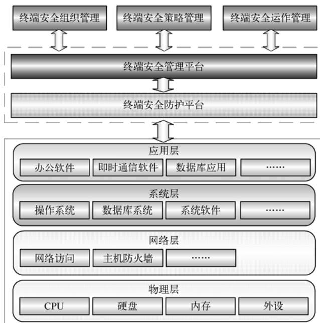
图 7-2 终端安全管理体系架构示意图
