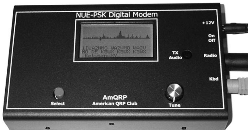
图 7-1 NUE-PSK3.1 型数字调制解调器
