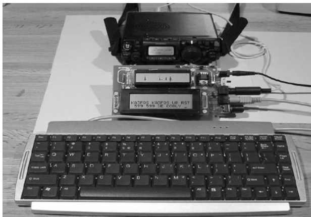
图 7-3 NUE-PSK3.1 型数字调制解调器外部连接示意图
