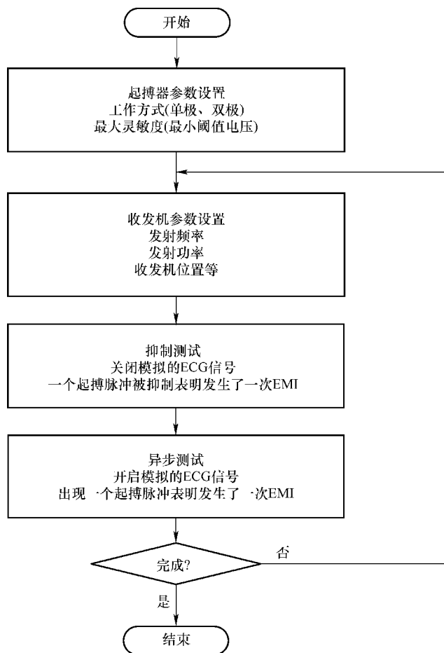
图 7.31 心脏起搏器 EMI 测试过程
