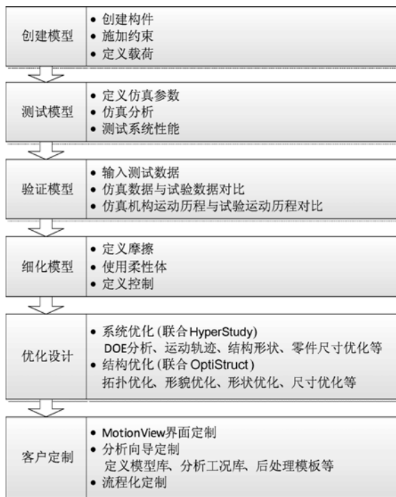
图 1-10 应用 MotionView & MotionSolve 软件进行虚拟样机设计的一般流程
