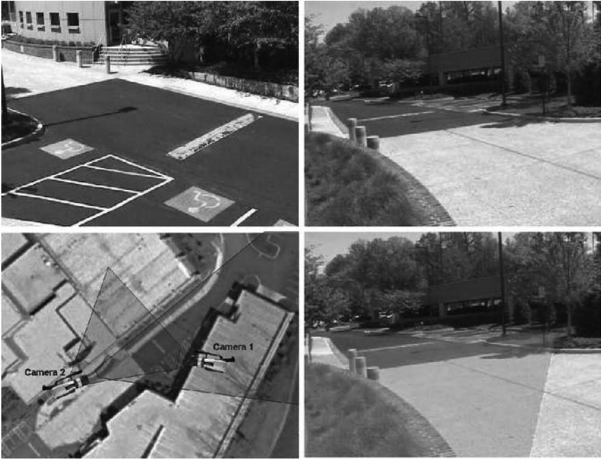
图 13.6 视场重叠视觉传感器的无监控校准：（上面一行）摄像机视图，（左下）摄像机装置；（右下）进行持续 5min 的目标观测，通过单应性估计得到了变形的图像
