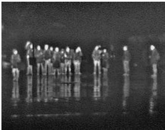
图 18.11 对于远红外辐射光来说，潮湿路面的反射
