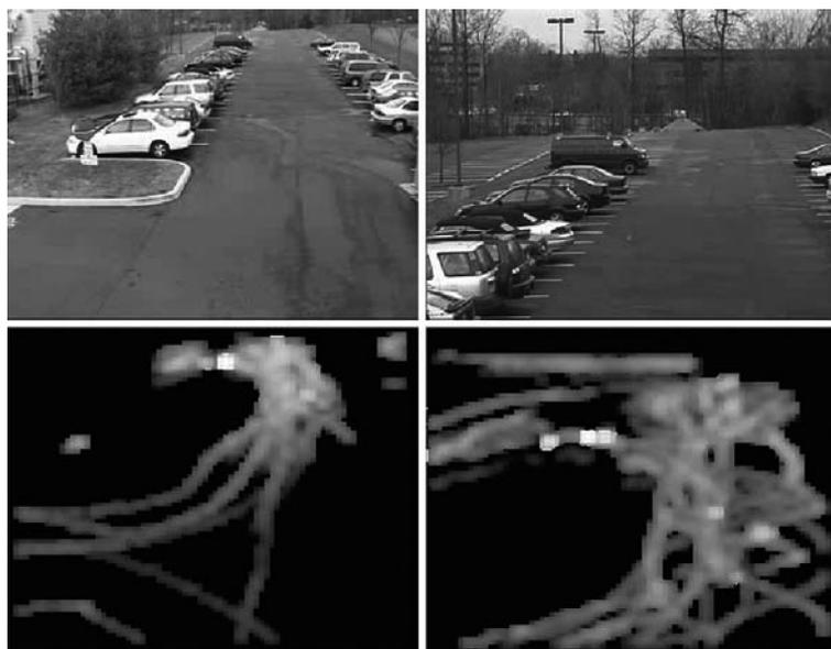
图 17.9 上面一行：来自两个摄像机的图像，它们的视场存在交叠；下面一行：四维共现概率密度函数关于  $x$ 、 $y$  坐标方向的二维边缘概率密度
