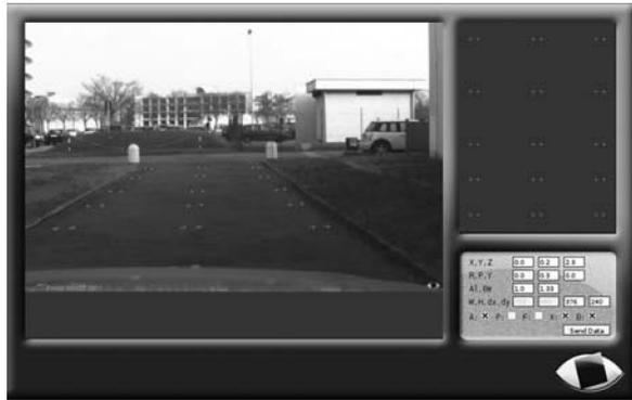
图 18.7 VisLab 开发的一个便携的摄像机校准工具
