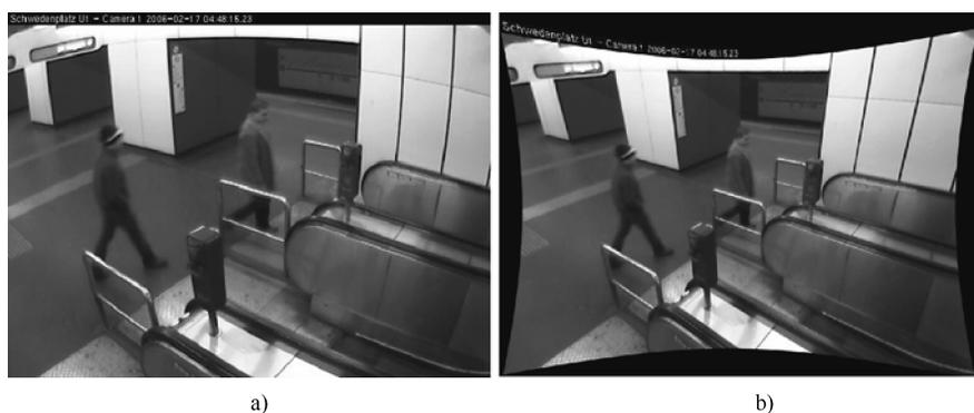
图9.2 桶形失真自动降低<sup>[421]</sup>,但没有完全消除,因为左上角的图片部分分辨率低(弱边缘信息)
