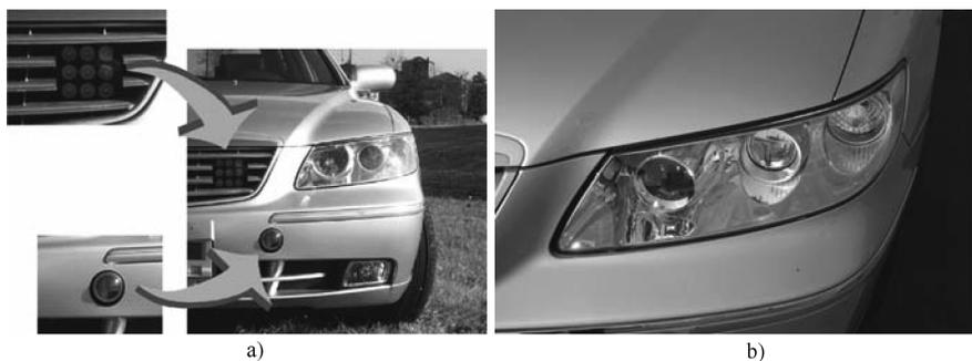
图 18.5 a) 为两个不同类型的近红外灯在试验车辆上的安装位置。b) 为夜视照明系统的组成，左边是低（高）光束灯，中间是 NIR 灯，右边是停车灯。
