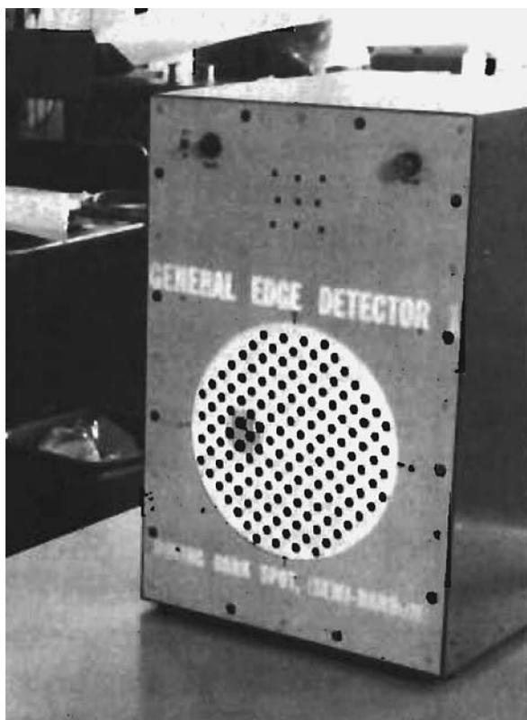
图 1.7 Runge 等人的鸽子视网膜，具有传感器阵列。模型采用离散模拟网络<sup>[461]</sup>，镉硫化物光电传感器，视角约 40°
