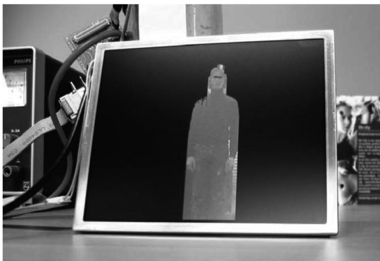
图 12.12 利用背景减除法来识别摄像机前面的人的轮廓，这些轮廓将作为眼睛识别应用的输入，图中用水平条标出的部位为眼睛
