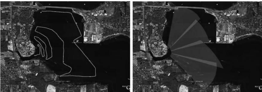
图 13.3 半监控传感器校准：左图为一个典型的 GPS 跟踪，为了更好地校准，将其设计为水平的；右图通过所提出的算法得到了港口中四个摄像机的视场
