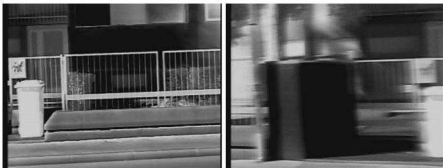
图 18.8 FIR 域图像的运动模糊实例, 它是通过车载视觉系统获得的: 当车辆静止时, 获取左边的图像, 而仅在几秒之后, 当车辆向左转时, 拍摄了右边的图像, 结果显示右边的图像有严重的水平运动模糊问题
