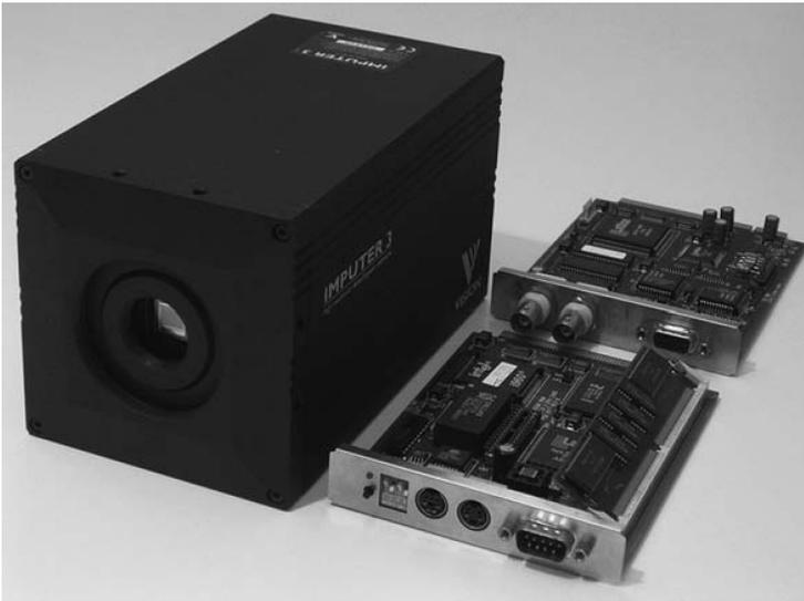
图 1.10 VLSI Vision 的 imputer3 体积为  $105 \times 105 \times 180\text{mm}$ ，以英特尔的 i960 CPU 为基础设计。它的模块化概念使得定制的组件可以与工业外设直接接口（如光耦合 I/O、ADC、DAC 等）
