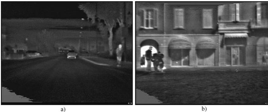
图 18.2 a) 在冬天的场景中, FIR 图像能很容易检测到人和车辆。
