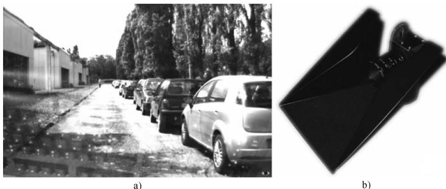
图 18.4 当存在反射时，车载摄像机获得的彩色图像为 a)。为避免摄像机的传感器受到反射的干扰，可能的解决方案在图 b) 中展示出来
