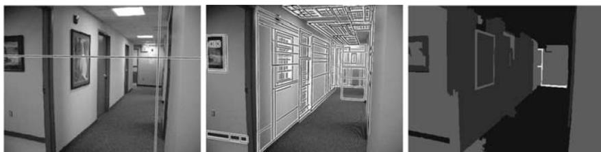
图 9.8 线性结构的检测,从左边开始:①输入内嵌消失线的图像。②用 Micusik 等人提出的方法<sup>[380]</sup>检测四边形。③基于 Markov 随机场的方法,并利用已经提取的四边形将图像部分分割成三个正交面。每个平面用不同的灰度级描述,最亮的表示“未定”像素。
