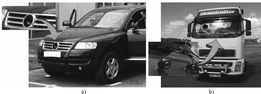
图 18.3 FIR 视觉系统集成的实例
