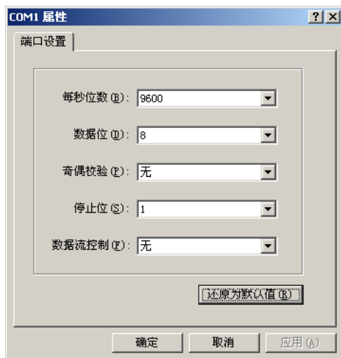
图 10-8 超级终端中串口通信参数的设置
