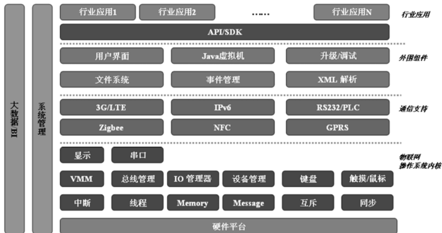
图 1-7 物联网操作系统的大致架构
