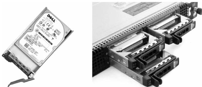
图 3-4 服务器热插拔 SAS 硬盘
