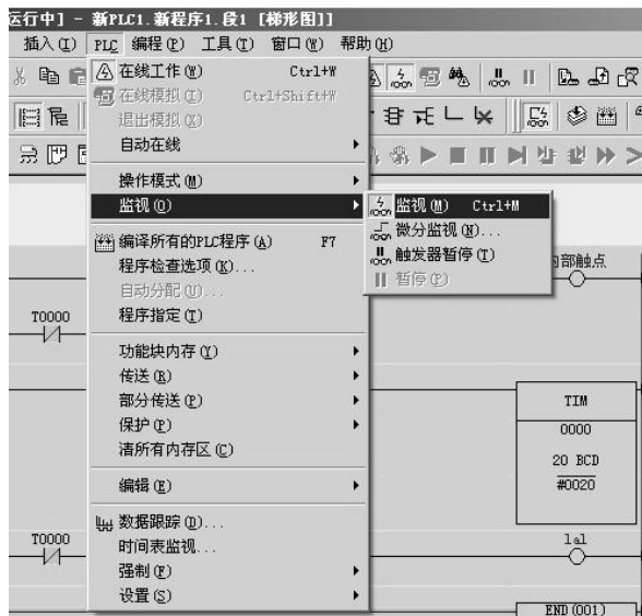
图 4-56 设置上位机在线监视 PLC
