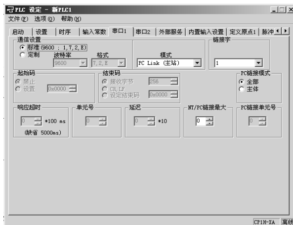
图 9-12 主 PLC 串口 1 设定图
