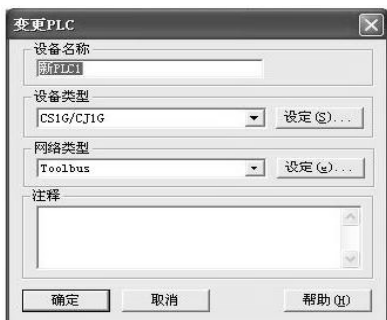
图 4-2 配置 PLC 设备
