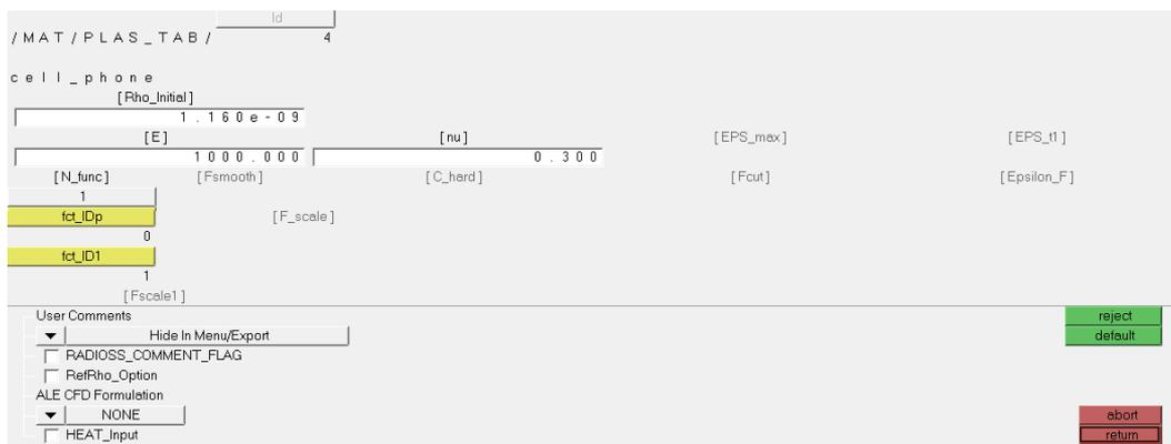
图 15-46 定义 cell\_phone 材料
