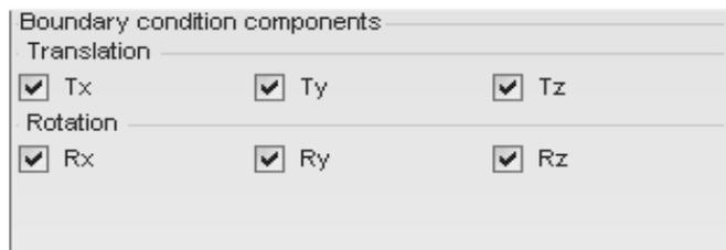
图 16-62 约束 Support 刚体的所有自由度
