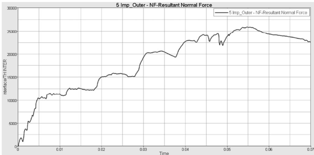
图 16-74 压头接触力时间历程曲线
