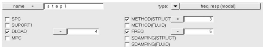
图 7-14 创建模态频率响应分析载荷步
