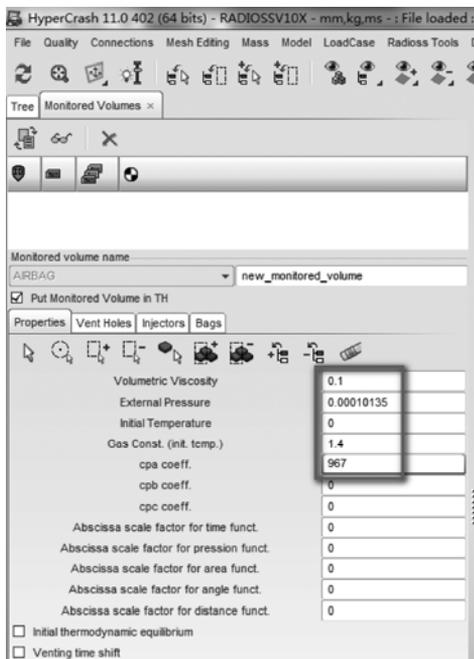
图 19-31 均压气囊参数
