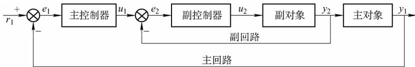
图 3-31 串级控制系统结构
