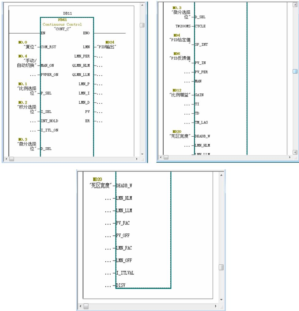
图 6-29 带死区的 PID 控制模块示意图
